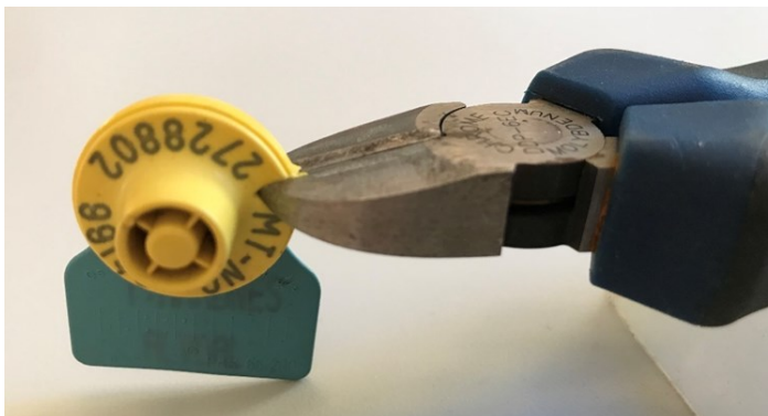
Slik øydelegg du elektronikken i eit elektronisk øymerke.
